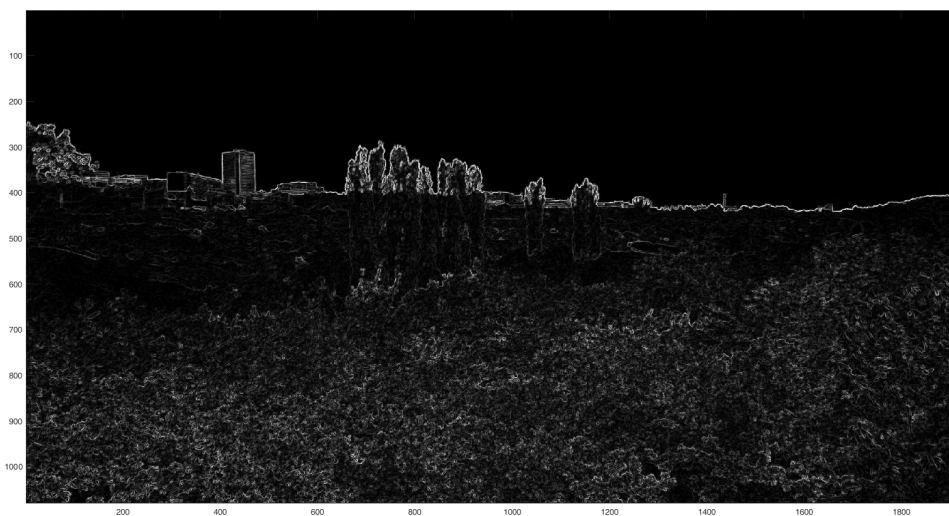
Obrázek 8.2: Obraz po průchodu hranovým detektorem
